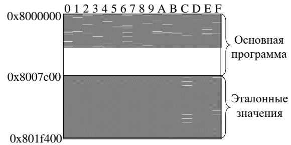
Рис. 7. Фрагменты адресного пространства ПЗУ МК с отличающимися значениями (■) от эталонных при воздействии АМ-сигнала с F_{\text{АМ}} = 1 кГц; f_{\text{АМ}} = 144 МГц; M = 80 \% ; P_{\text{вх}} = 25 дБм
