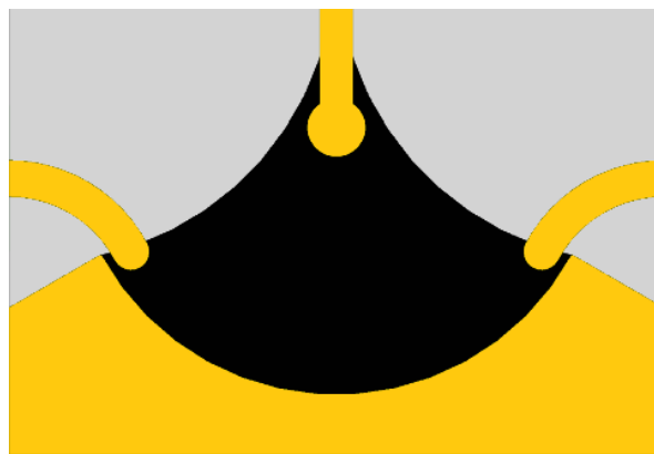
Рис. 6. Топология микрополосковой резистивной нагрузки с ответвителями
