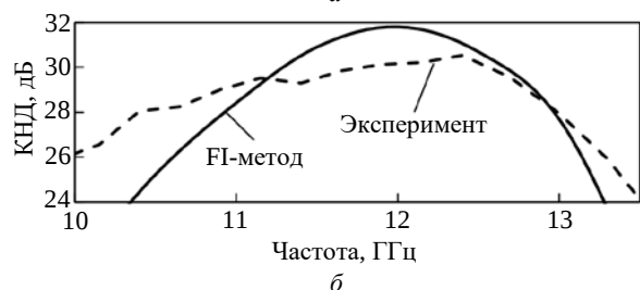
Рис. 9. Для конформной уголкового ОАР: а – вид конформной уголкового ОАР; б – измеренная и численная частотные зависимости КУ
