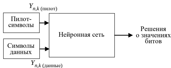
Рис. 3. Прием OFDM-сигнала с помощью нейросети общего вида
