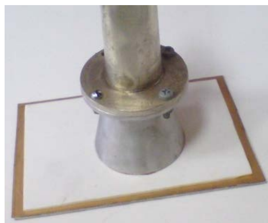
Рис. 1. Измерение фазы коэффициента отражения от дискового элемента: а – измеренные зависимости фазы коэффициента отражения от однослойного элемента на различных частотах в сравнении с результатом численного моделирования; б – вид исследуемых элементов; в – фрагмент экспериментальной установки
