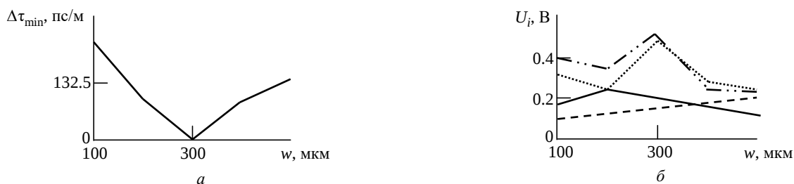
Рис. 8. Зависимости \Delta\tau_{\min} (а) и U_1(-) , U_2(---) , U_3(\cdots) и U_4(-\cdots-) (б) от одновременно изменяемых w_1 , w_2 , w_3 и w_4 при s_1 = 200 мкм и s_2 = 1000 мкм
