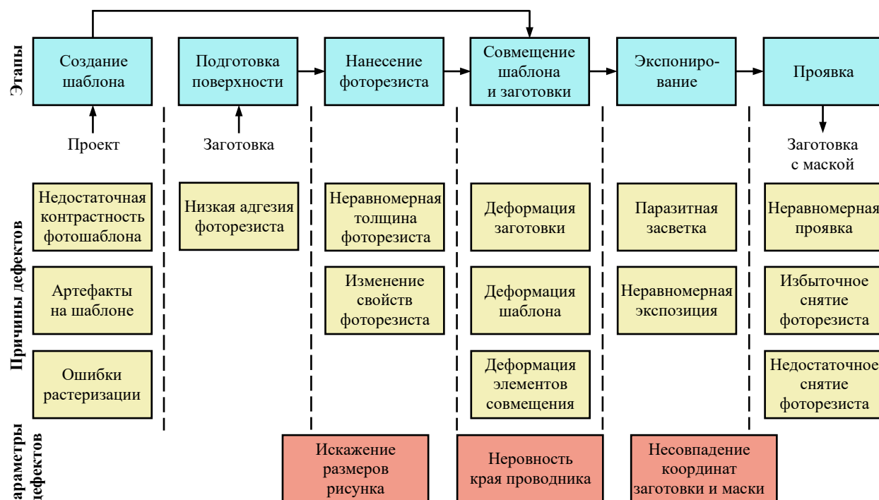
Рис. 2. Этапы процесса фотолитографии, причины и параметры дефектов
