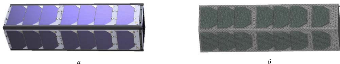
Рис. 9. Космический аппарат CubeSat 3U: а – CAD-модель; б – CAE-модель
