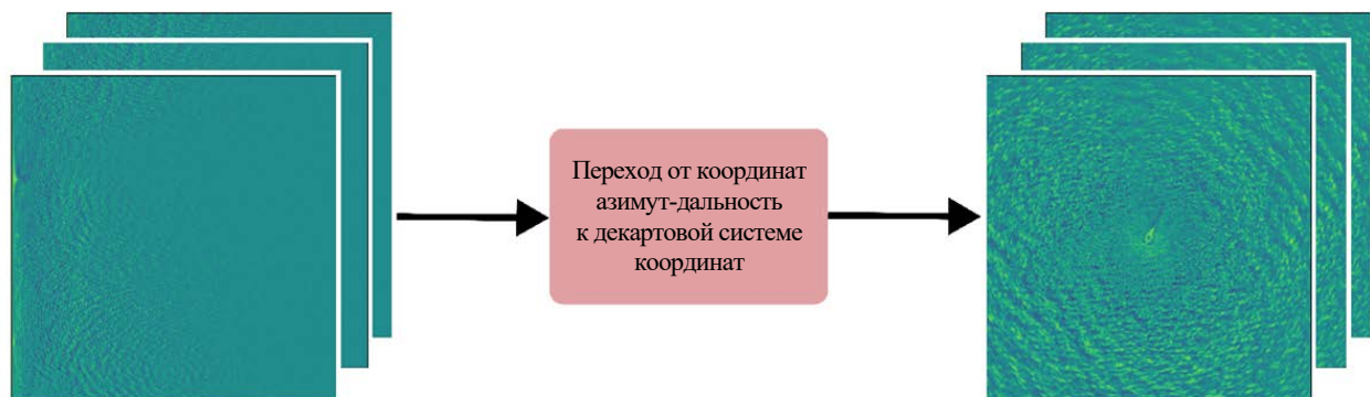
Рис. 4. Перевод данных из системы "азимут-дальность" в декартову систему координат
