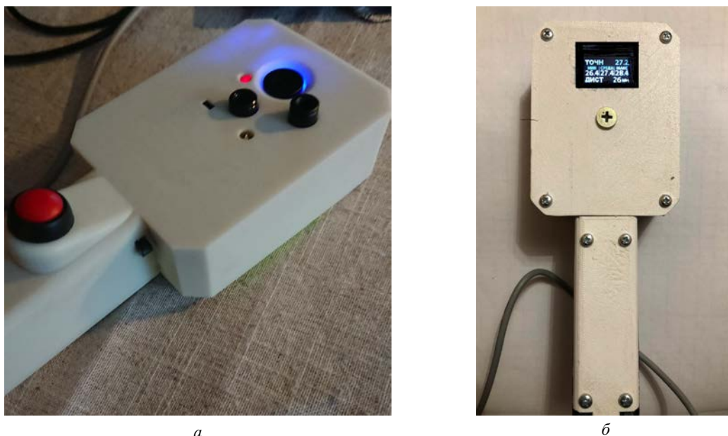
Рис. 3. Материальный макет тепловизора ТВС-2: а – лицевая сторона корпуса; б – тыльная сторона корпуса
