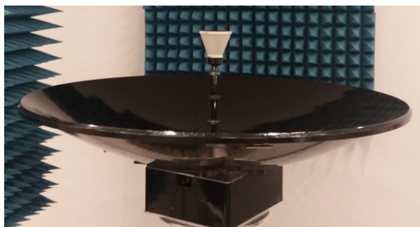
Рис. 1. Внешний вид зеркальной антенны 08150.6220-0, разработанной АО ИСС для ЗССС Ka/Q-диапазонов
