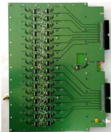
Рис. 4. Плата питания МШУ-Ф со снятой экранирующей крышкой
