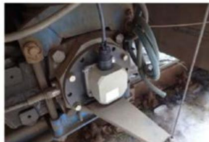
Рис. 1. Система обнаружения коротких импульсных неровностей
