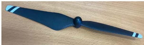
Рис. 10. Винт квадрокоптера DJI Phantom 3
