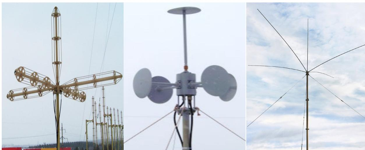
Рис. 1. Примеры триортогональных антенных элементов
