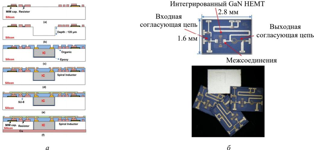
Рис. 5. Типичный процесс интеграции в подложку (а) и фотографии изготовленных усилителей мощности X-диапазона частот (б) [26]
