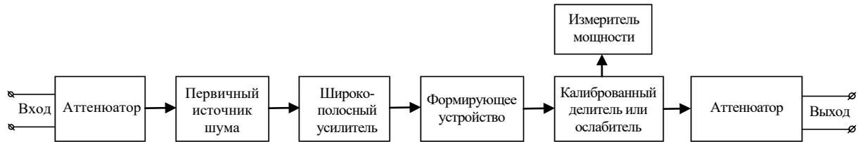
Рис. 3. Функциональная схема ГШ [1]
