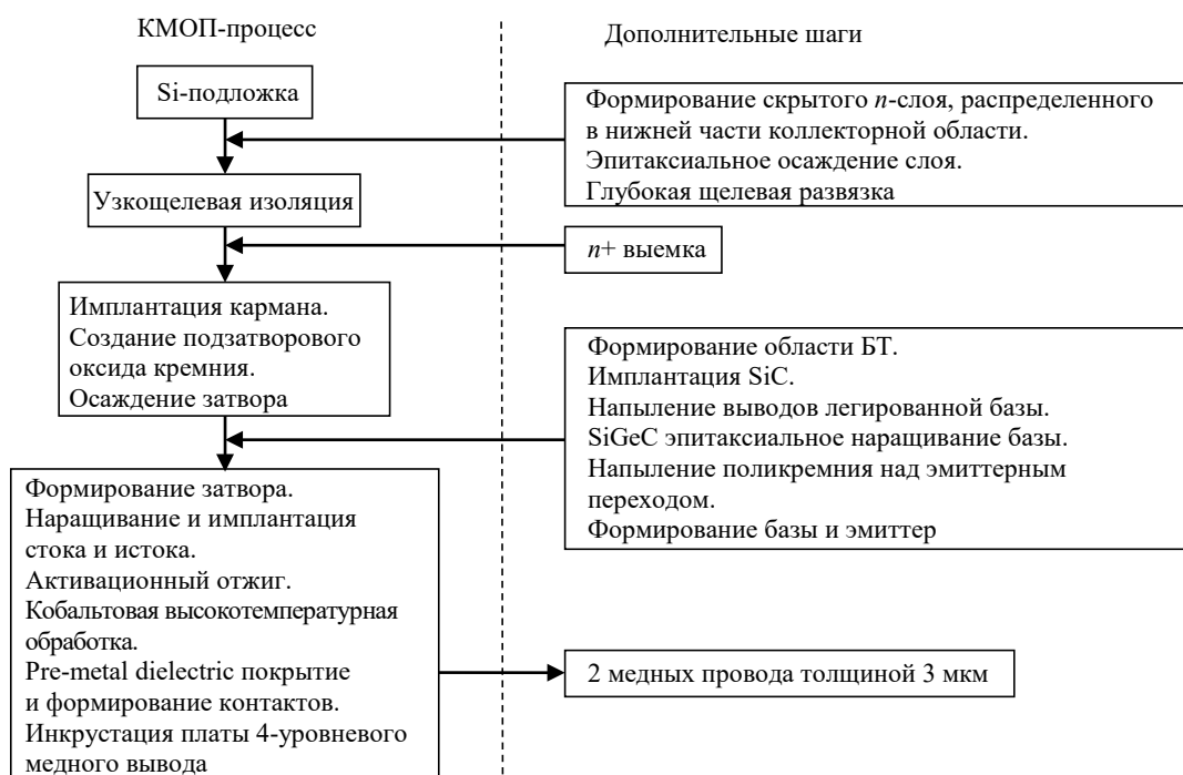
Рис. 16. 0.13-мкм технология интеграции биполярного транзистора в КМОП-процесс (БиКМОП) [50]
