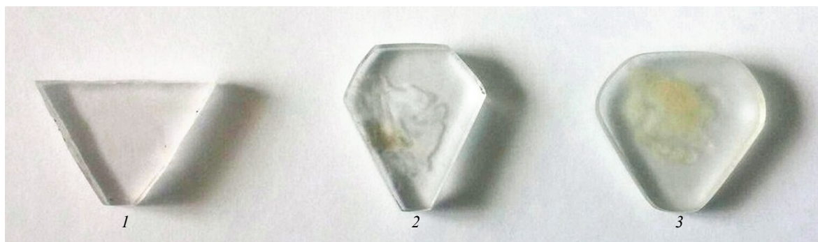
Рис. 2. Три образца концентратора, изготовленных из ПММА
