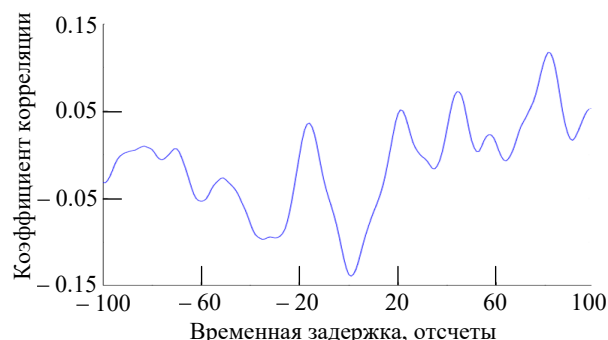
Рис. 8. Коэффициент корреляции двух сигналов акселерометров при отсутствии дефекта
