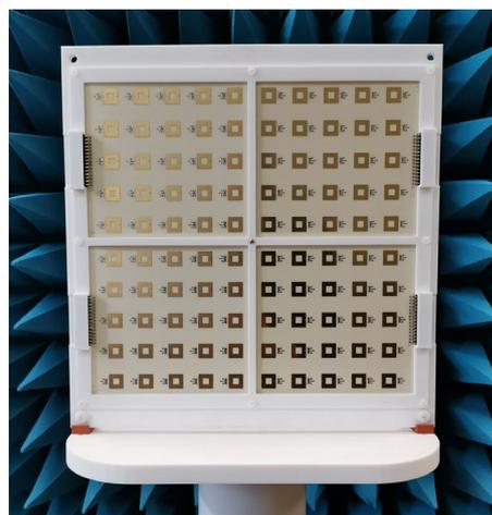
Рис. 10. Экспериментальный прототип проходной фазированной антенной решетки с пространственным возбуждением
