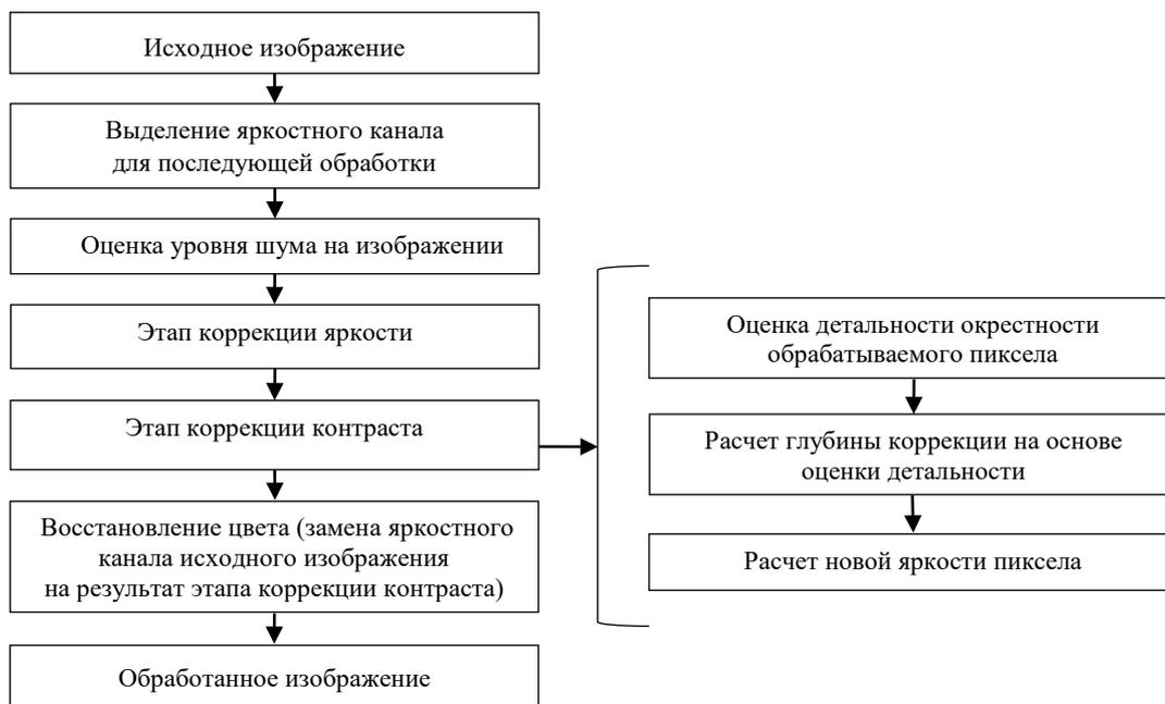
Рис. 8. Структурная схема предложенного метода
