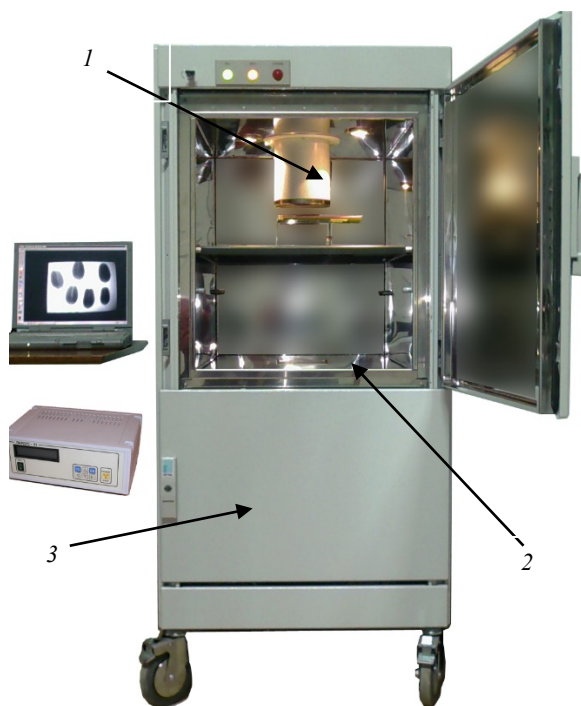
Рис. 2. Семейство ПРДУ: 1 – источник рентгеновского излучения; 2 – цифровой приемник изображения; 3 – специализированная камера для проведения рентгенографических работ
