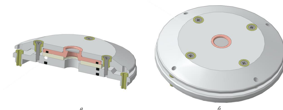
Рис. 5. Конструкции анодного узла разборной рентгеновской трубки: а – срез; б – общий вид Fig. 5. Anode assembly design in a demountable X-ray tube: a – cross-sectional view; б – general view
