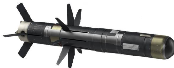
Рис. 1. Внешний вид ракеты комплекса FGM-148 Javelin Fig. 1. FGM-148 Javelin Anti-Tank Guided Missile
