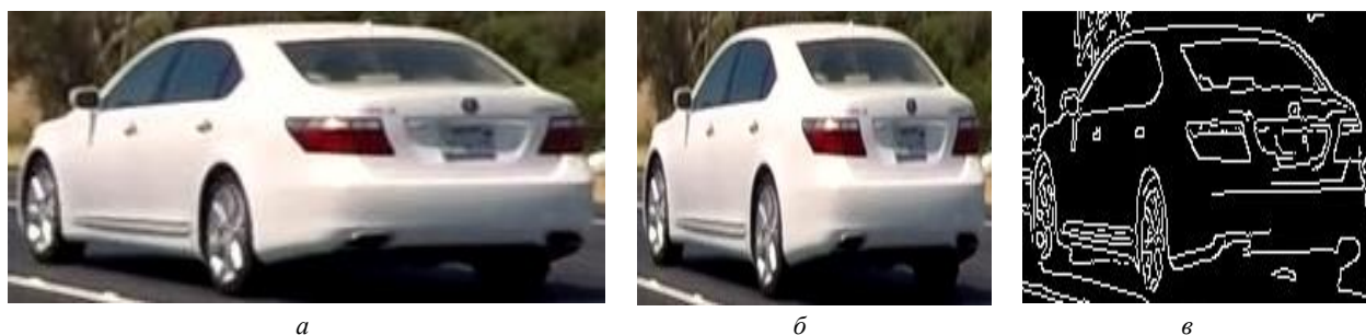
Рис. 6. Предобработка изображения: а – исходное изображение выделенного объекта; б – масштабированное изображение; в – результат обработки детектором Кэнни
