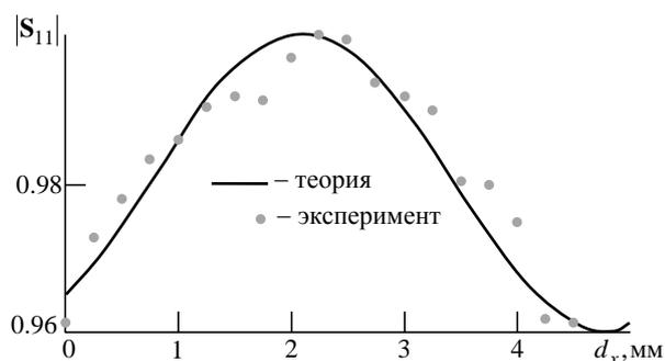
Рис. 9. Коэффициент отражения механического эквивалента ФВ
