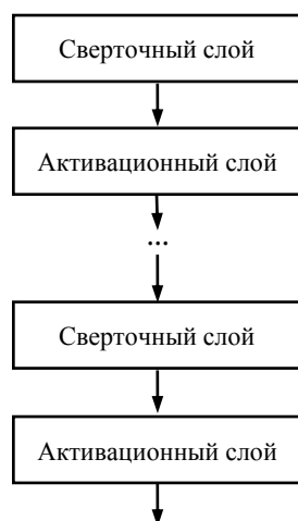
Рис. 1. Базовая структура сверточной нейронной сети
