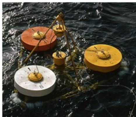
Рис. 2. Клеверовидный ВБ, способный измерять кривизну волн
