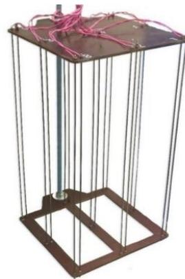
Рис. 7. Струнный электролитический волнограф с девятью парами струн для экспериментального исследования разработанного метода
