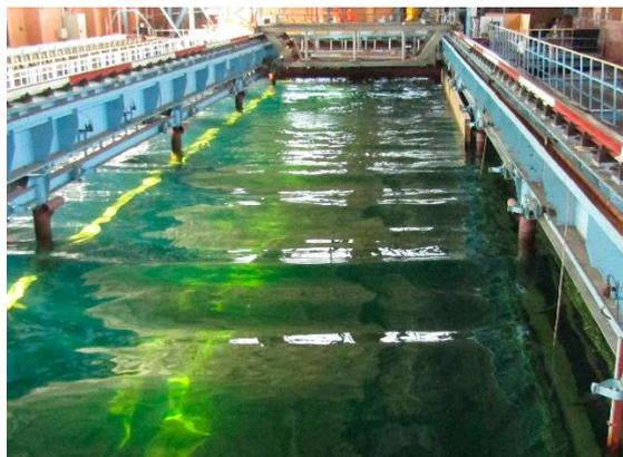
Рис. 6. Моделируемое волнение в опытовом волновом бассейне
