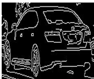
Рис. 3. Результат обработки объекта рис. 2, б детектором Кэнни
