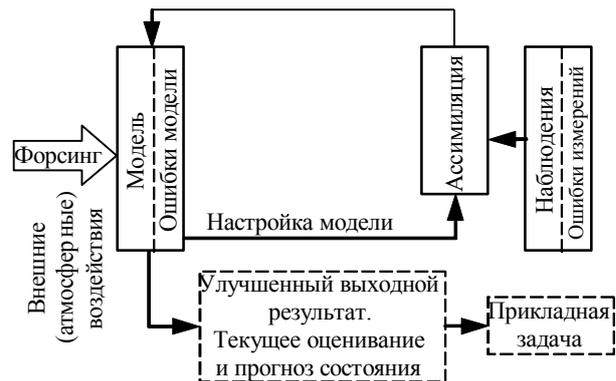
Рис. 8. Система оперативной океанографии с элементами настройки (адаптации) моделей и наблюдательной сети
