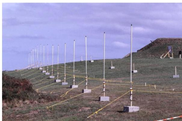
Рис. 6. Антенная система РЛС WERA
