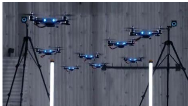
Рис. 5. Системы OptiTrack для БПЛА в помещении [38]
