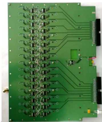
Рис. 4. Плата питания МШУ-Ф со снятой экранирующей крышкой
