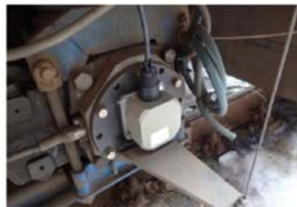
Рис. 1. Система обнаружения коротких импульсных неровностей Fig. 1. System for detecting short impulse irregularities
