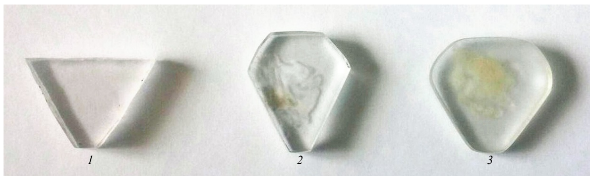
Рис. 2. Три образца концентратора, изготовленных из ПММА
