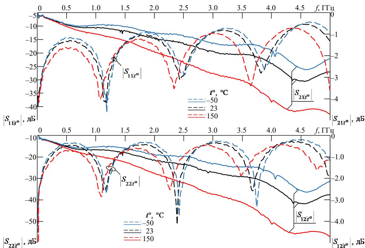
Рис. 11. Частотные зависимости  $S$ -параметров печатных плат с МР и отказом типа ХХ при разных температурах
