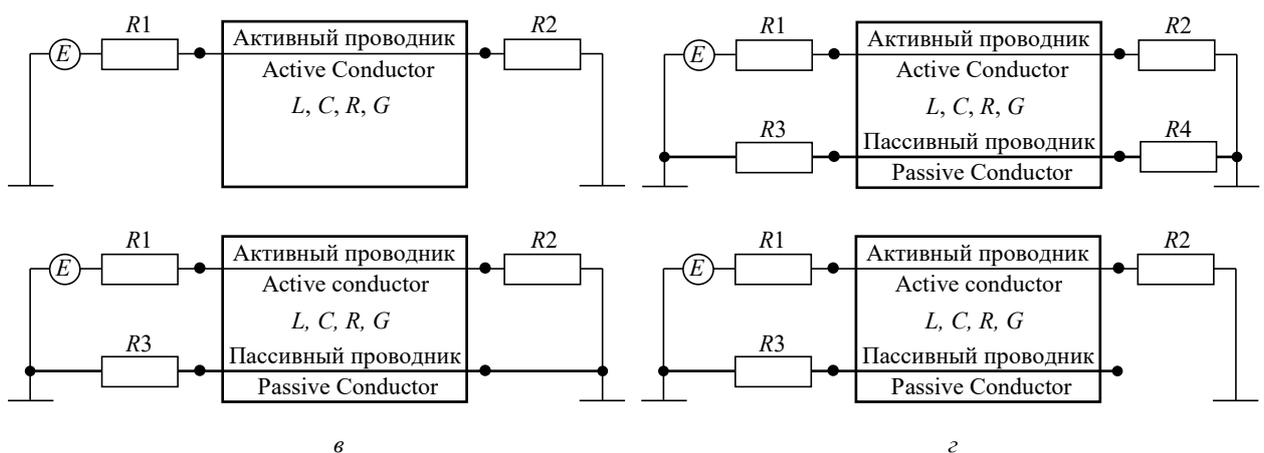
Рис. 3. Эквивалентные схемы макетов МПЛ: а – без МР; б – с МР при полном согласовании пассивного проводника; в – с МР при КЗ пассивного проводника на выходе; г – с МР при ХХ пассивного проводника на выходе
