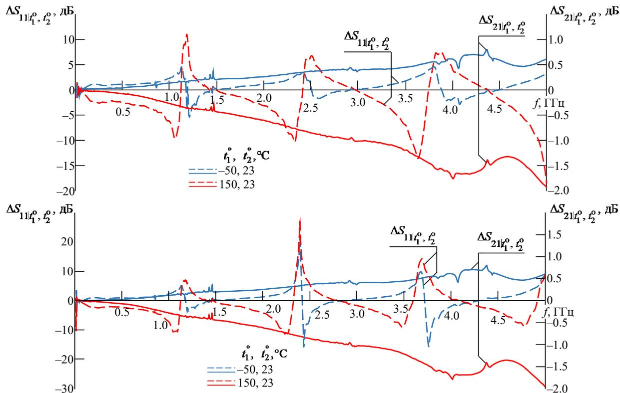
Рис. 12. Частотные зависимости разницы значений  $S$ -параметров печатных плат с МР после отказа типа ХХ при температурах  $-50$  и  $150$  °C и при комнатной температуре
