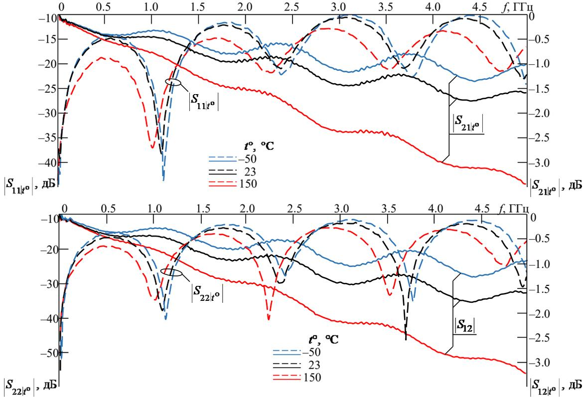
Рис. 5. Частотные зависимости  $S$ -параметров печатных плат без МР при разных температурах
