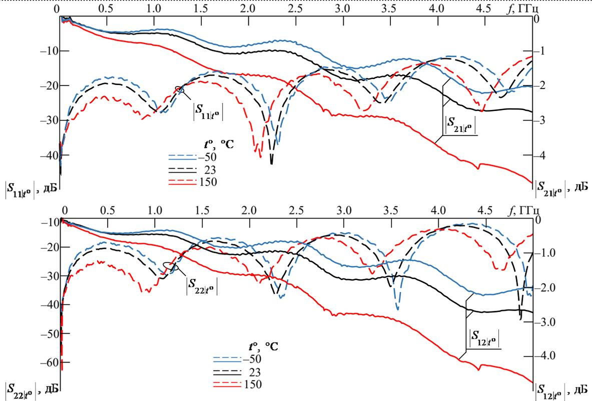
Рис. 9. Частотные зависимости  $S$ -параметров печатных плат с МР и отказом типа КЗ при разных температурах
