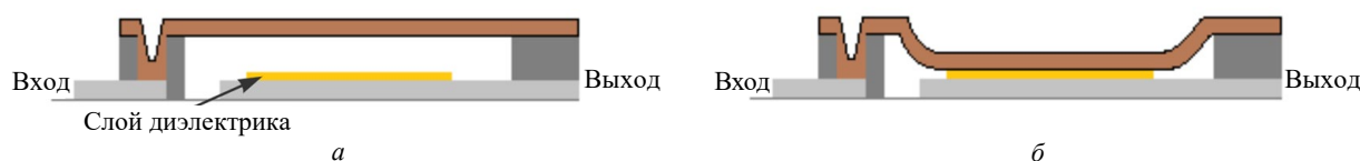
Рис. 3. Упрощенное изображение МЭМС-переключателя с емкостным контактом: а – в выключенном; б – во включенном состояниях
