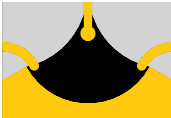
Рис. 6. Топология микрополосковой резистивной нагрузки с ответвителями
