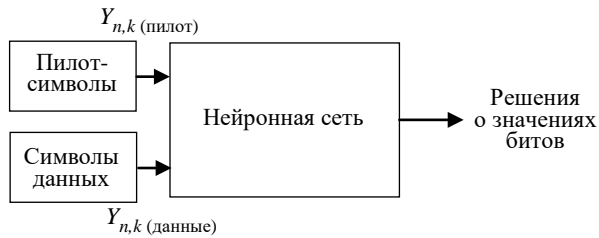
Рис. 3. Прием OFDM-сигнала с помощью нейросети общего вида
