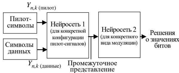
Рис. 4. Прием OFDM-сигнала с помощью модульной нейросети
